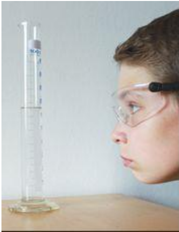
Richtig: waagerechter Blick auf die Skala
