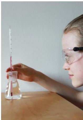
Richtig: waagerechter Blick auf die Skala
